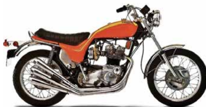
Die Triumph Hurricane X75 wurde mit 1172 Einheiten im 1972/73 in Meriden/GB hergestellt. Die wohl charakteristische Darstellung mit den 3 in 3 Auspuffanlage, sowie diese Tanksitzkombination in Glasfaser zeichnen diese spezielle Bike aus.
