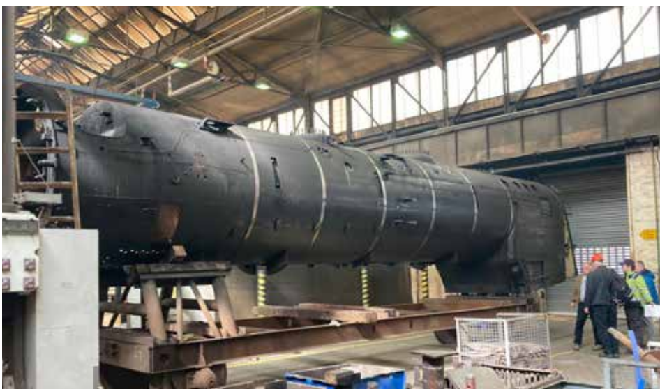
Der abgehobene Kessel der 01 202
