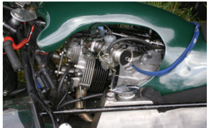
Triumph T100, liegend eingebaut
