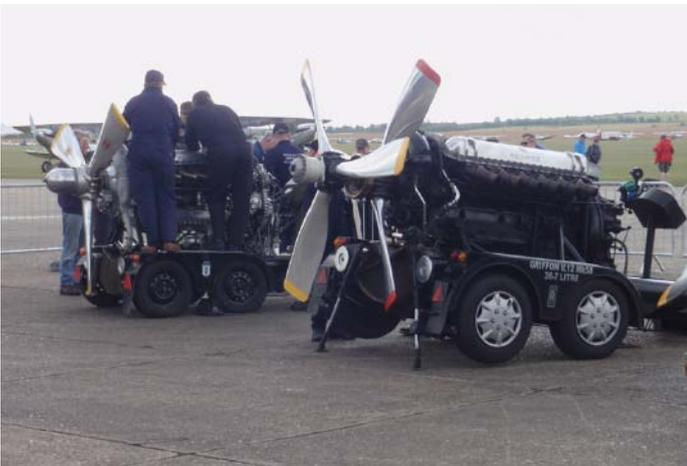
Diese Motoren sind auf Anhänger montiert. Im Moment läuft die Vorbereitung zum Start. Wenn die Teile laufen, ist der Lärm und Rauch absolut unbeschreiblich. Die technischen Daten: V12 36,7 lt und über 2'000 hp
