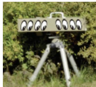
sind schräg versetzt. Dadurch kann die Anlage auch gut für Geschwindigkeitsmessungen in der Kurve eingesetzt werden, da sie nicht wie andere Typen im rechten Winkel zur Fahrbahn aufgestellt werden müssen.
