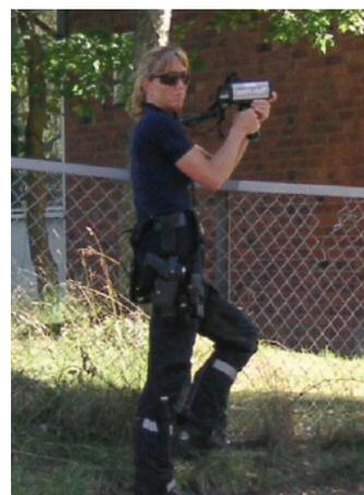
trolle ein. Sie senden kurze Lichtimpulse aus, die vom Töff reflektiert werden. Dabei wird jeweils der Abstand zwischen Töff und Laserpistole ermittelt, aus diesen Distanzen und der Zeitdifferenz errechnet sich die Geschwindigkeit. Der Vorteil dieser Geräte ist ihre kompakte Bauform, die einen mobilen Einsatz (gehalten werden sie ähnlich wie eine Pistole oder eine Maschinenpistole) ermöglicht und keine aufwendigen Auf- und Abbauarbeiten mit Stativen etc. benötigt.
